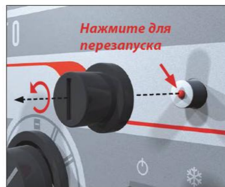
Рис.9 Перезапуск котла в случае перегрева
