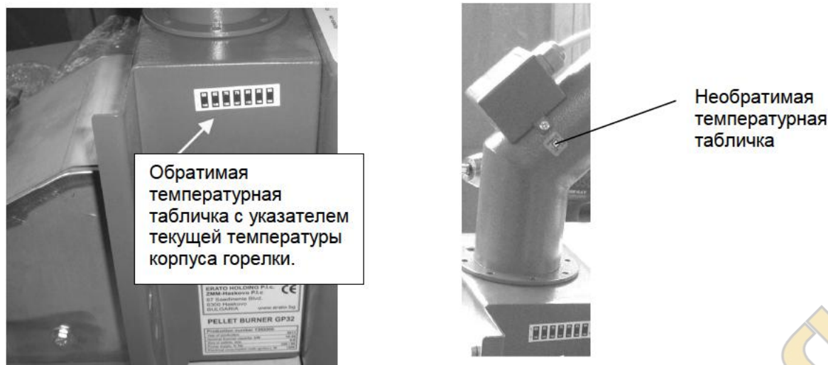
Рис. № 7 Размещение температурных табличек на горелке
