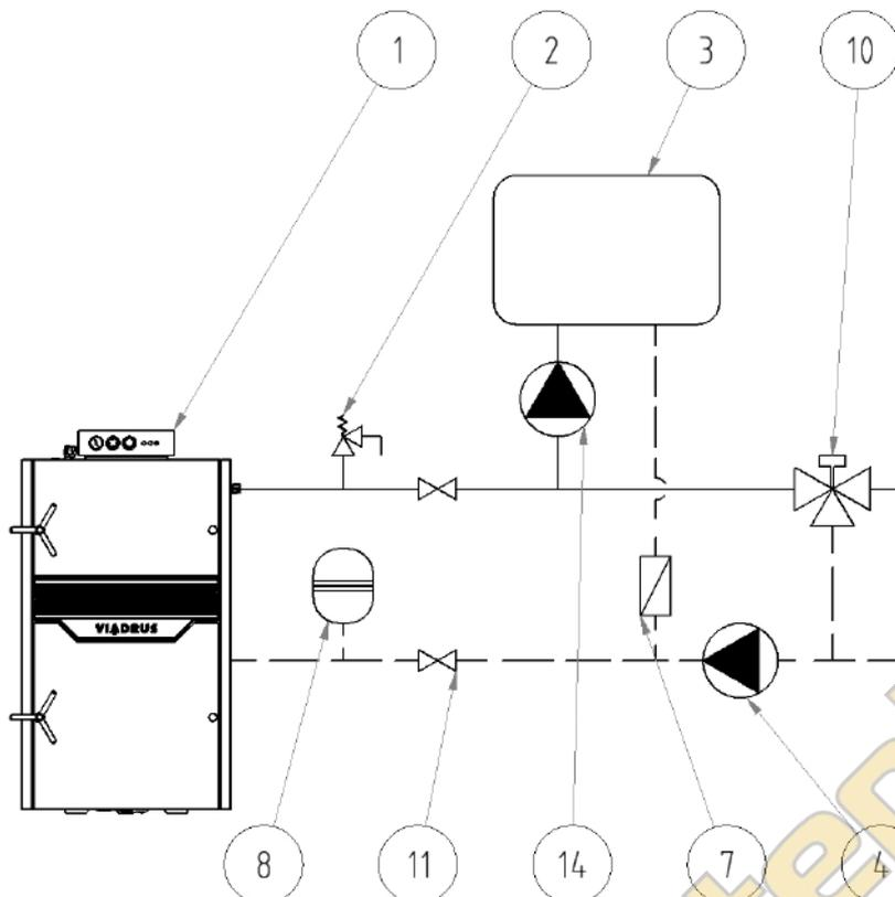
Рис. 17 Рекомендуемая схема включения котла с трехходовым смесительным вентилем
