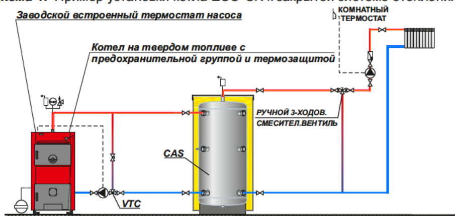
Схема 1. Пример установки котла ECO-СК к закрытой системе отопления
