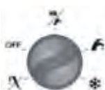
Регулятор котла, установлен в позицию разблокировки
