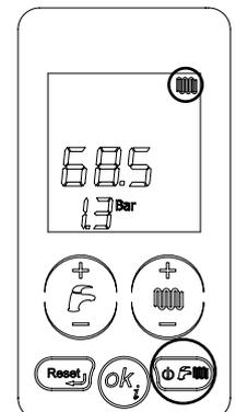
6. Для регулировки температуры ГВС нажимайте на кнопки + и - горячего водоснабжения (A на рис.1). Отрегулируйте температуру по своему желанию.
