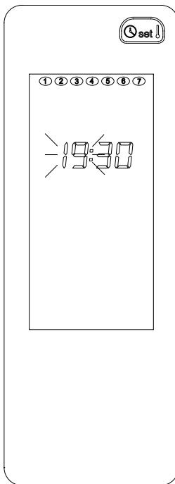
**2-** С помощью кнопок «+ и – отопление», Вы можете изменить значения параметров, которые мигают на дисплее. Нажмите кнопку «ок» для подтверждения нового значения или кнопку "reset", для того чтобы вернуться на стартовую страницу. Нажимая кнопку "set" Вы переходите к регулированию «ночного» и «дневного» уровней температуры, так как это описано в следующем параграфе.
