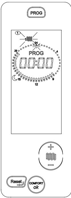
**1-** На дисплее отображается мигающий символ зоны 1, а также пиктограмма солнца или луны в зависимости от того, горят или не горят отметки на часах в 00:00 часов. Циферблат отображает программу, установленную для 1го дня (понедельник), при этом мигает отметка на 00:00 часов.
