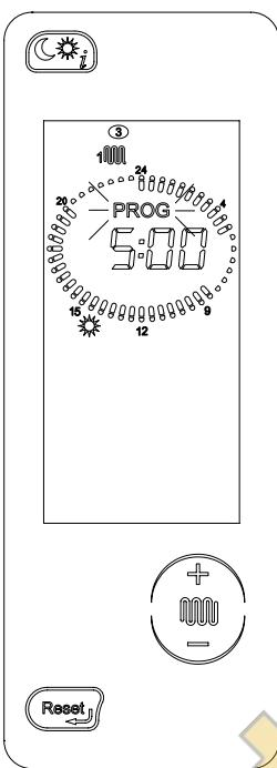
**3-** Регулируемый временной интервал отображается мигающим сектором на циферблате. Данная информация дублируется также в цифровом виде по центру циферблата. Нажимая кнопку «солнце/луна», мы можем выбрать для данного интервала «дневной» или «ночной» уровень температуры (при этом на дисплее отобразится пиктограмма «солнце» или «луна» соответственно). Переход между временными интервалами осуществляется посредством кнопок «+ и - отопление». Кнопками «+ / - отопление» можно устанавливать время.
