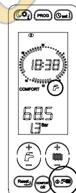
4. Если необходима одновременная работа котла в режимах отопления и ГВС, нажмите несколько раз кнопку "выбора режима работы" пока на дисплее не появится символ .
