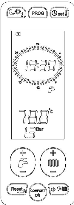
Выбор «РУЧНОЙ» программы работы котла, которой соответствует пиктограмма , позволяет ему круглосуточно работать, придерживаясь «дневного» уровня температуры, при этом исключается работа зоны отопления 1 и зоны отопления 2 по собственным временным программам. Данная процедура не касается бойлера, который при этом будет работать по своей программе.
