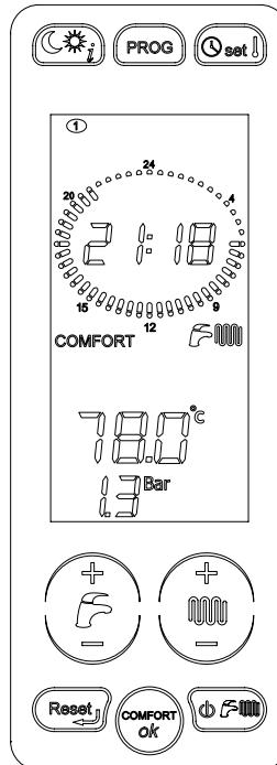
**1-** При подключенном датчике температуры наружного воздуха, с помощью кнопок «+» и «-» отопления (поз **E** на рис. 1) возможно установить фиктивную комнатную температуру. По окончании установки символ «фиктивной температуры» будет мигать еще в продолжении 3 с, даже если при этом есть запрос в контуре ГВС.
