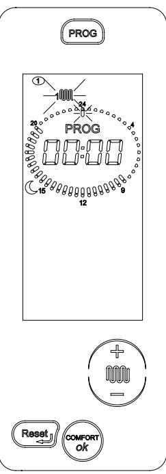
Для того чтобы выйти из режима программирования необходимо нажать кнопку «reset» два раза. Порядок изменения программ зоны отопления 2 и бойлера, аналогичен таковому для зоны отопления 1. Нажимая кнопку "prog" мы можем изменять 4 программы: «ручная», зона отопления 1, зона отопления 2, бойлер.
