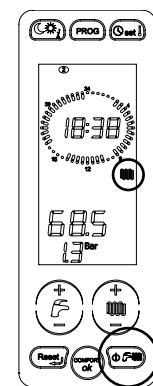
6. Для регулировки температуры ГВС нажать кнопки "+ - ГВС" (**D** на рис. 1). Регулировать впоследствии температуру соответственно с собственными потребностями.
