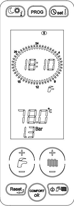
Когда к плате управления котла подключены 1 или 2 датчика температуры помещения, есть возможность установить два желаемых температурных уровня. При этом котел будет управлять системой отопления в зависимости от данных настроек. Если к котлу не подключены датчики температуры помещения, возможность устанавливать температурные уровни отсутствует. «Дневному» уровню температуры соответствует пиктограмма ☀, а «ночному» ⚡.
