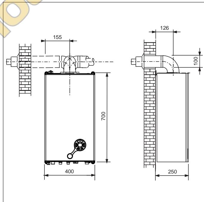
Рис. 11 Размеры коаксиальных труб типа C13 - C33
