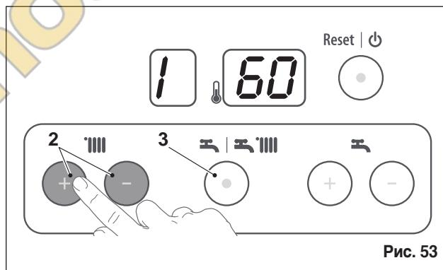
На дисплее отобразится значение температуры в подающей линии.
