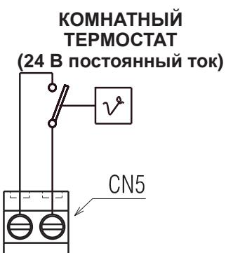
Комнатный термостат (24В-- ) подключается как показано на схеме. Предварительно необходимо снять перемычку, установленную на 2-х контактном разъёме (CN5).
