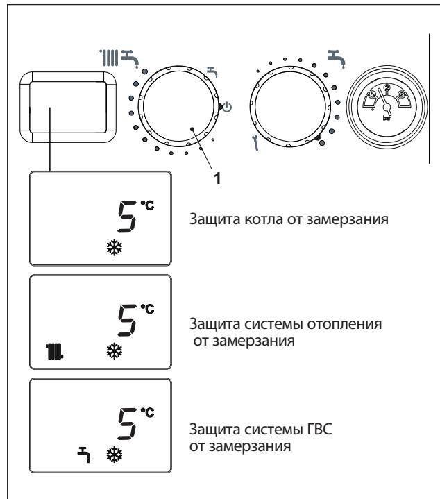
При этом электропитание остаётся подключённым, а трубопровод подачи топлива открытим. Котёл будет защищён следующими функциями:
