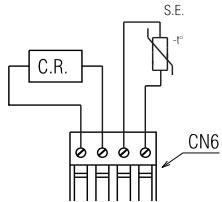
регулятор комнатной температуры (24В) подключается, как показано на схеме. Сначала необходимо снять перемычку на клеммной колодке с 2 контактами (CN5).
