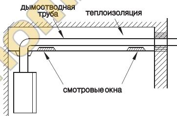
· При удлинении дымоотводящей трубы следует использовать хотя бы один хомут для подвешивания на каждые 900 мм трубы (если длина более 1м). Неправильная установка дымоотводящей трубы приводит к неэффективной работе котла, а также может стать причиной различного рода ущерба. Во избежание этого следуйте всем инструкциям, содержащимся в данном руководстве.
