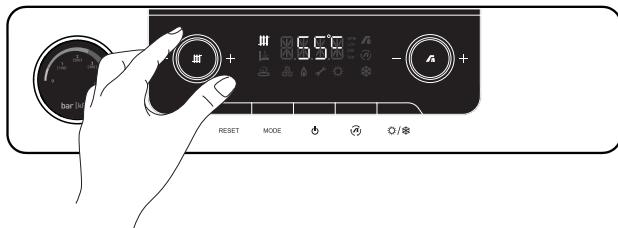
В режиме дисплея поворотом ручки можно отрегулировать температуру воды отопления. Во время регулировки температуры мигает символ или , и на дисплее значение температуры сменяется.
