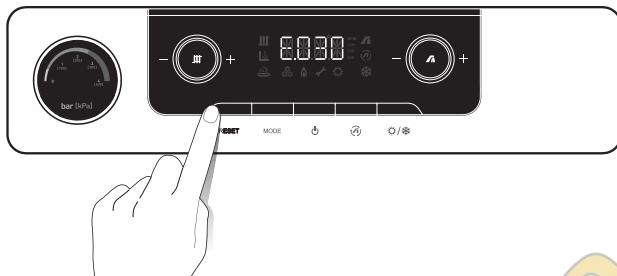
Если во время работы котла происходит сбой, загорается символ и на дисплей выводится код ошибки, которые мигают попеременно с шагом в 1с. При нажатии кнопки сброса (**RESET**) на дисплее в течение 3с отображается надпись "RST", после чего, в случае автоматического устранения неисправности, ошибка устраняется. Если этого не произошло, снова загорается символ и на дисплей выводится код ошибки, которые мигают попеременно с шагом в 1с. Информацию о кодах неисправностей См. на стр. 50.
