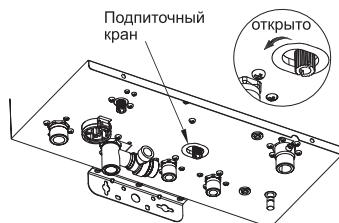
4.2.Когда показания стрелки манометра окажется в пределах 1,2-2 бар, закройте подпиточный кран.
