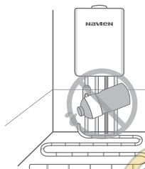
3. Котлы NAVIEN Prime оснащены встроенным сетчатыми фильтрами отопительной воды. На обратном трубопроводе системы отопления, перед котлом, рекомендуется установить дополнительный косой сетчатый фильтр, для очистки отопительной воды от нежелательных примесей.
