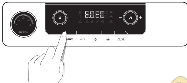
Если во время работы котла происходит сбой, загорается символ и на дисплей выводится код ошибки, которые мигают попеременно с шагом в 1с. При нажатии кнопки сброса (**RESET**) на дисплее в течение 3с отображается надпись "RST", после чего, в случае автоматического устранения неисправности, ошибка устраняется. Если этого не произошло, снова загорается символ и на дисплей выводится код ошибки, которые мигают попеременно с шагом в 1с. Информацию о кодах неисправностей См. на стр. 51.
