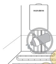
3. Котлы Navien Smart Tok оснащены встроенным сетчатым фильтром отопительной воды. На обратном трубопроводе системы отопления, перед котлом, рекомендуется установить дополнительный косой сетчатый фильтр, для очистки отопительной воды от нежелательных примесей.
