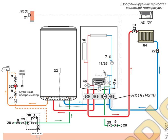
MSL 24 MI (FF), подключенный к солнечной установке, с 1 прямым контуром отопления, который управляется при помощи датчика наружной температуры и программируемого терmostата комнатной температуры
