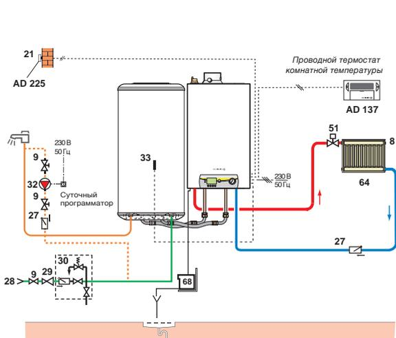
**MCR-P ... MI с 1 прямым контуром отопления. Управление при помощи беспроводного модулирующего термостата комнатной температуры «OpenTherm» и датчика наружной температуры**
