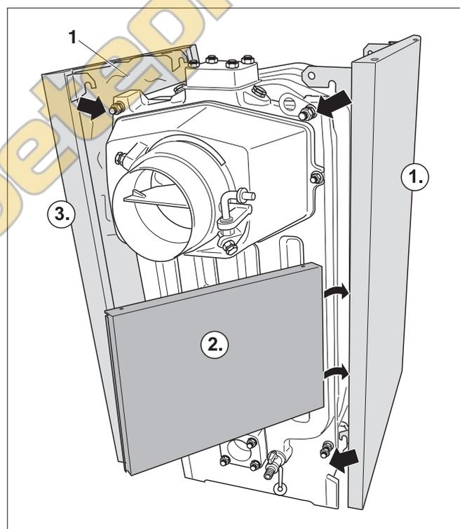
Рис. 7 Монтаж боковых стенок и задней стенки
