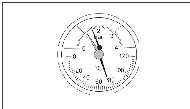
Рис. 28 Термоманометр
