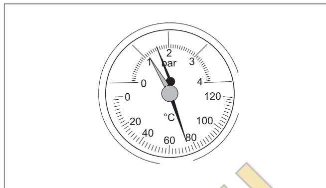
Рис. 16 Термоманометр
