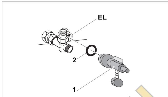
Рис. 24 Установка крана для наполнения и слива
