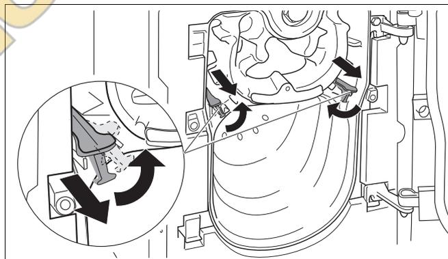
Рис. 35 Перестановка направляющих пластин дымовых газов
