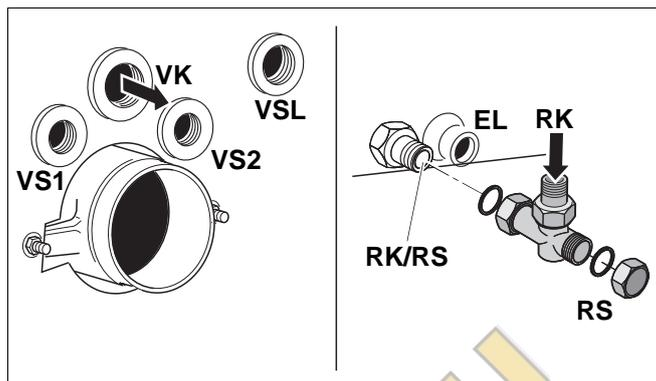
Рис. 21 Подключение подающей и обратной линий
