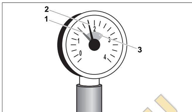
Рис. 46 Манометр для закрытых установок
