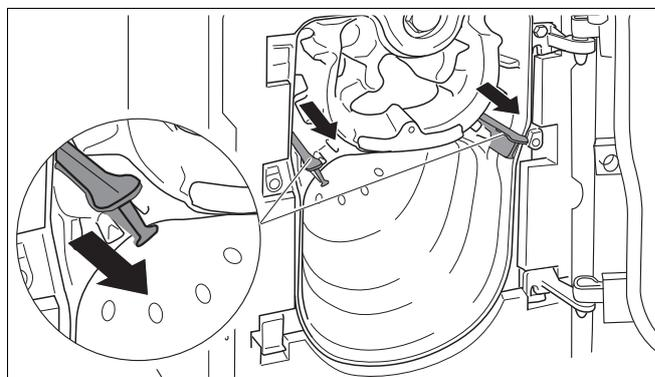
Рис. 36 Удаление направляющих пластин дымовых газов
