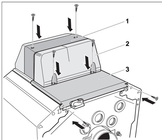
Рис. 30 Установка крышек
