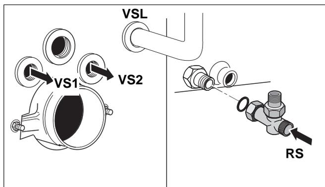
Рис. 23 Подключение бака-водонагревателя
