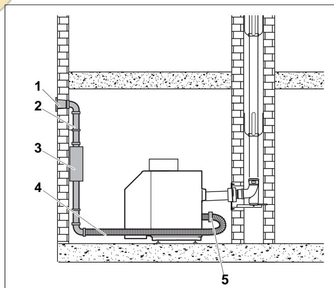
Рис. 18 Система подачи воздуха на горение и отвода дымовых газов (пример для вида монтажа OC<sub>53x</sub>)
