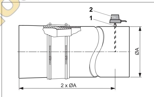
Рис. 53 Установка датчика температуры дымовых газов (принципиальная схема)
