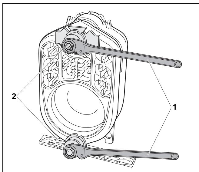
Рис. 15 Затяжка стяжных гаек ключами с трещоткой.
