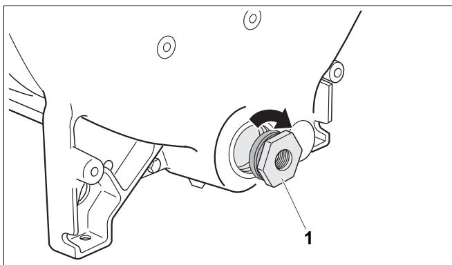
Рис. 24 Установка переходника
