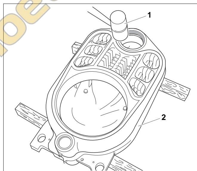
Рис. 10 Установка средней секции
