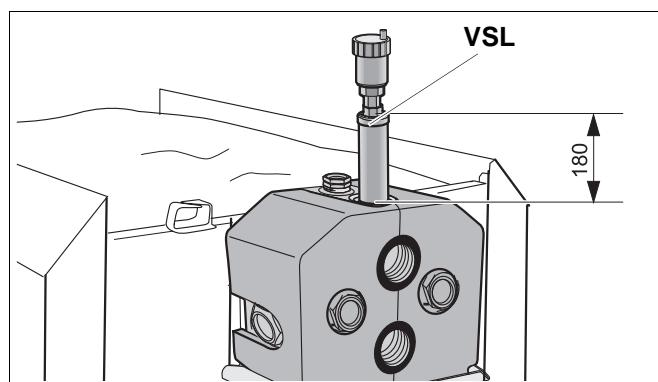
Рис. 55 Установка воздушного клапана на предохранительной подающей линии
