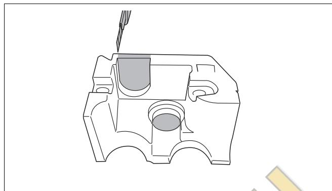
Рис. 47 Вырезание изоляции
