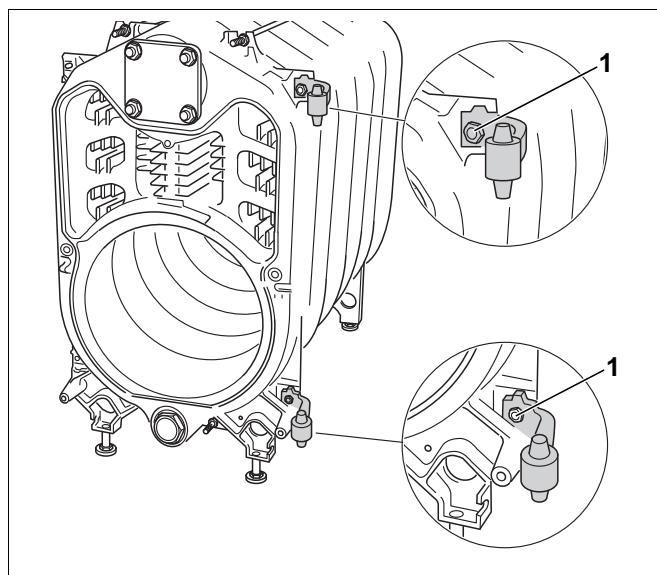
Рис. 31 Монтаж шарнирных крюков (здесь: с правой стороны)
