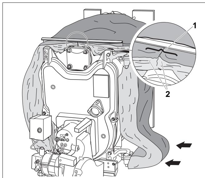
Рис. 37 Монтаж теплоизоляции
