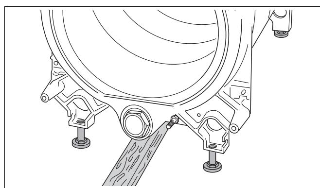
Рис. 28 Установка опорных болтов
