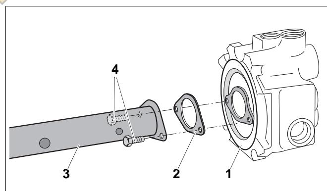
Рис. 18 Установка подпиточной трубы и соединительного элемента
