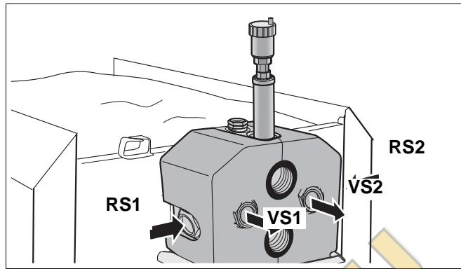
Рис. 56 Подключение бака-водонагревателя
