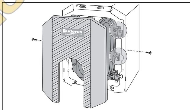
Рис. 4 Демонтаж обшивки дверцы горелки
