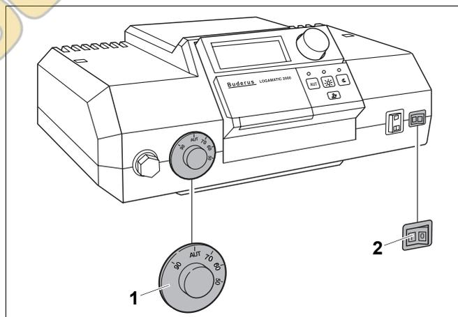
Рис. 35 Включение системы управления (например, Logamatic 2000)
