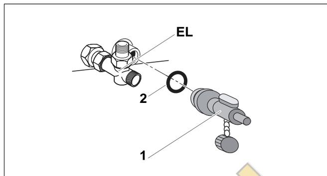
Рис. 22 Установка крана для наполнения и слива
