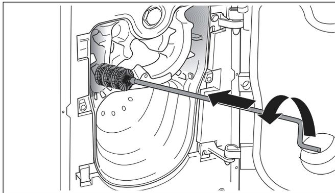
Рис. 43 Чистка щеткой газоотводящих каналов.
