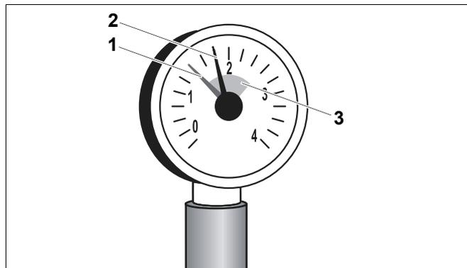
Рис. 45 Манометр для закрытых установок
