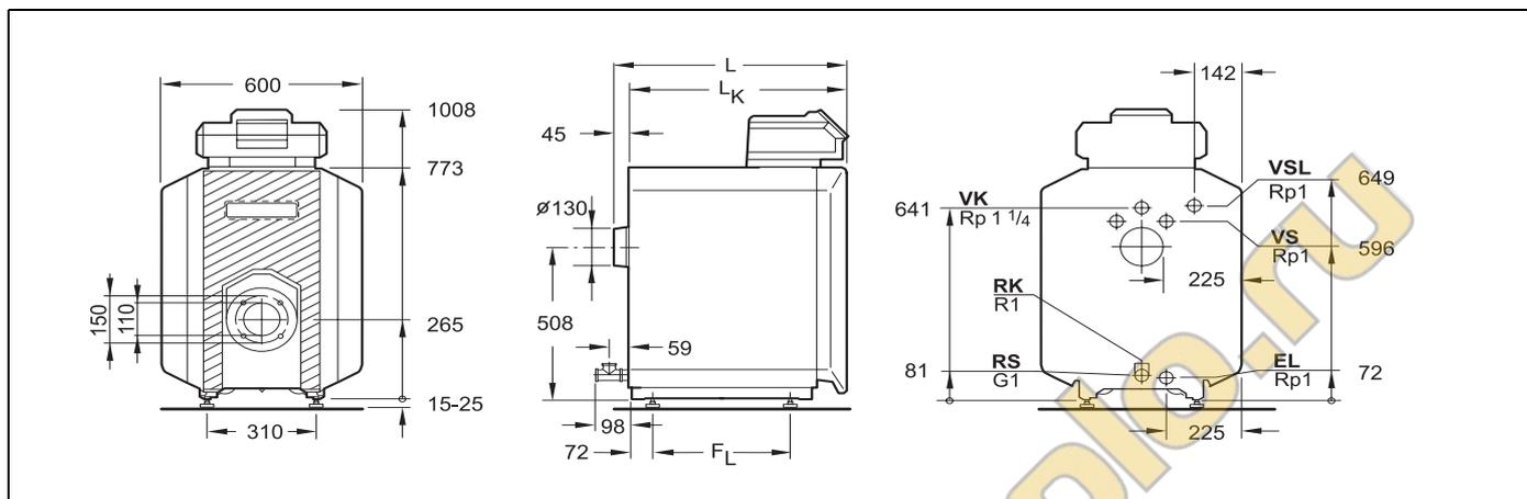
Рис. 2 Подключения и размеры (приведены в мм)
