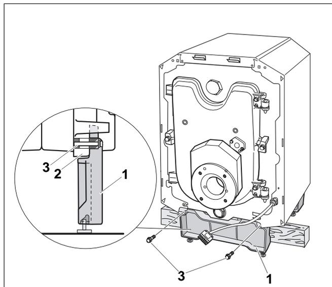
Рис. 13 Монтаж подставки под передней секцией котла
