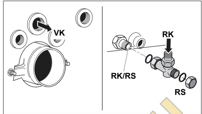
Рис. 19 Подключение подающей и обратной предохранительных линий
