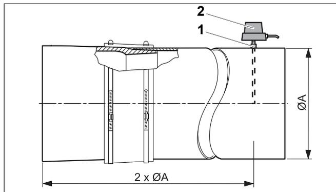
Рис. 16 Установка датчика температуры дымовых газов (принципиальная схема)
