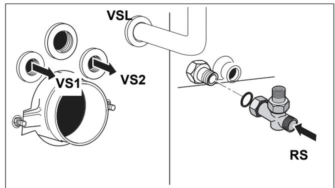
Рис. 21 Подключение бака-водонагревателя
