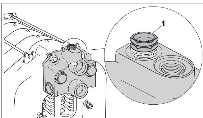
Рис. 28 Установка гильзы для датчиков
