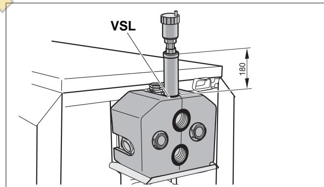
Рис. 53 Установка воздушного клапана на предохранительной подающей линии
