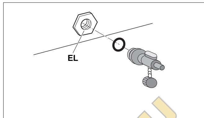
Рис. 55 Установка крана для наполнения и слива
