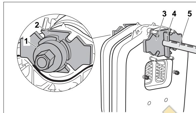
Рис. 13 Установка стяжного инструмента на верхней ступице котла
