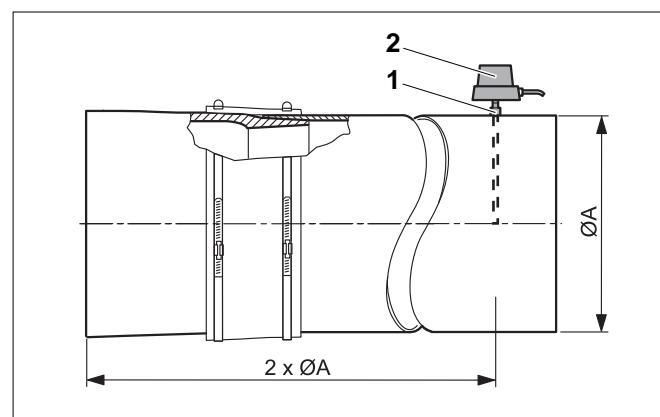
Рис. 51 Установка датчика температуры дымовых газов (принципиальная схема)
