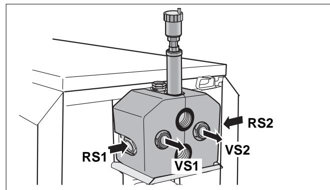
Рис. 54 Подключение бака-водонагревателя
