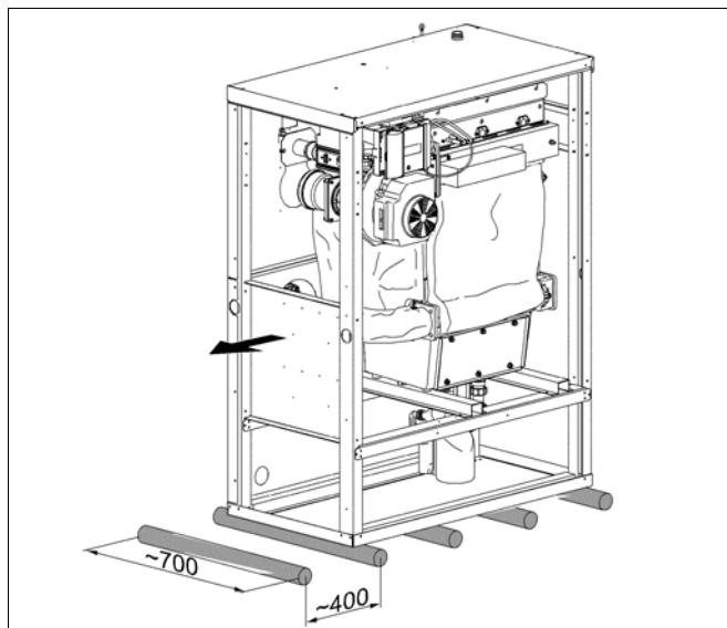
Рис. 7 Транспортировка котла перекатыванием на трубах (размеры в мм)
