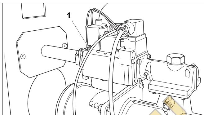
Рис. 44 Проверка герметичности в котлах 90 и 120 кВт
