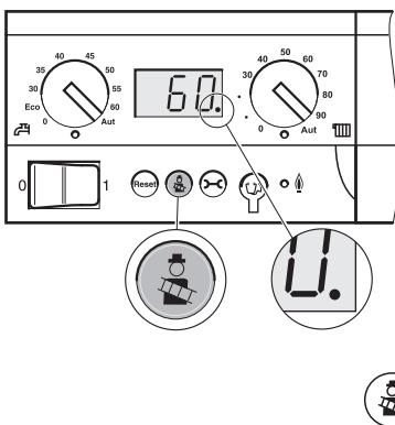
Кнопка "Трубочист" используется специалистом, обслуживающим дымовую трубу, для проведения теста дымовых газов.
