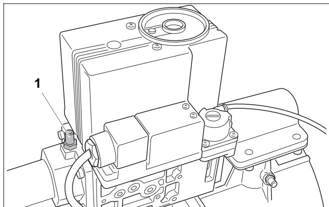
Рис. 30 Удаление воздуха из газопровода в котлах 160 - 280 кВт
