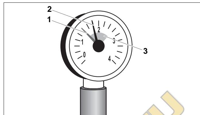
Рис. 47 Манометр для закрытых установок
