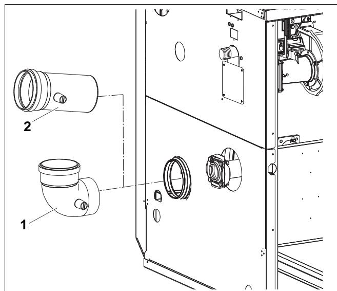
Рис. 10 Подключение дымохода
