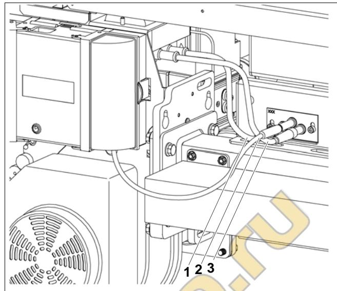
Рис. 50 Отсоедините электрические штекерные соединения от горелки
