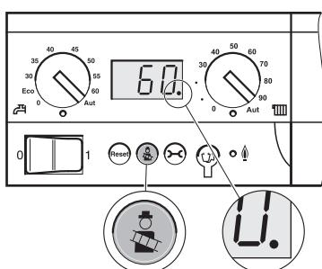
Кнопка "Трубочист" используется специалистом, обслуживающим дымовую трубу, для проведения теста дымовых газов.
