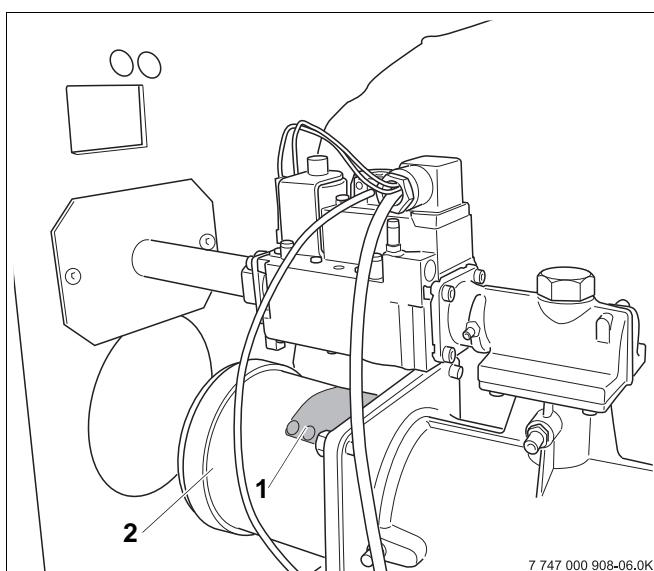
Рис. 33 Проверка мембранны приточного воздуха
