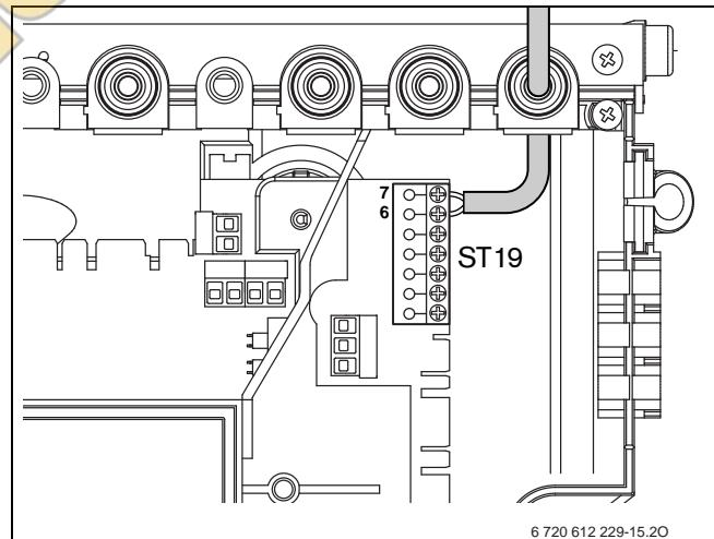
Рис. 16 Подключение регулятора
