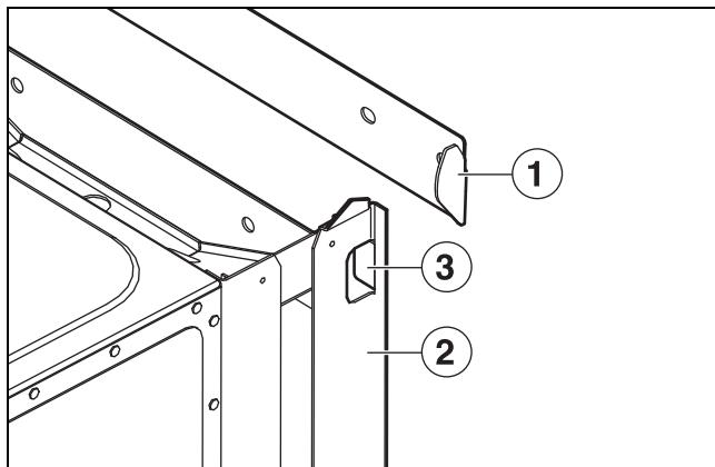
Рис. 11 Подвешивание прибора на планке для навески
