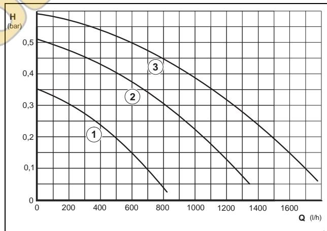
Рис. 33 Характеристическая кривая насоса на Logamax U052-24/28
