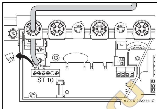
Рис. 15 Подключение Easyswitch
