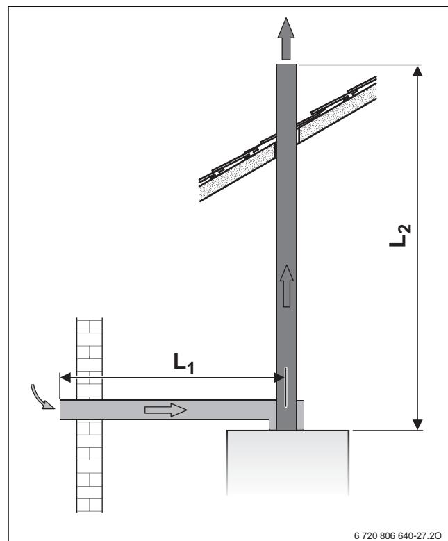
Рис. 12 Вертикальный отвод дымовых газов через отдельную трубу С<sub>52</sub>
