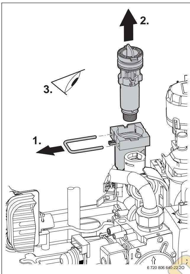
Рис. 38 Проверка фильтра в трубе холодной воды
