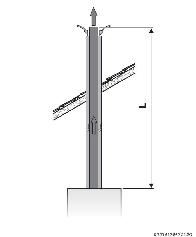
Рис. 10 Вертикальный отвод дымовых газов через концентрическую трубу С<sub>32</sub>
