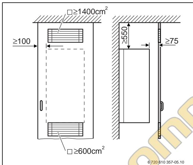
Рис. 6 Вентиляционные отверстия при установке в шкафу
