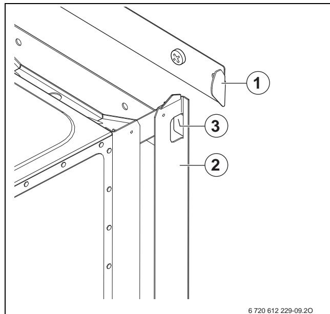
Рис. 10 Подвешивание прибора на планке для навески
