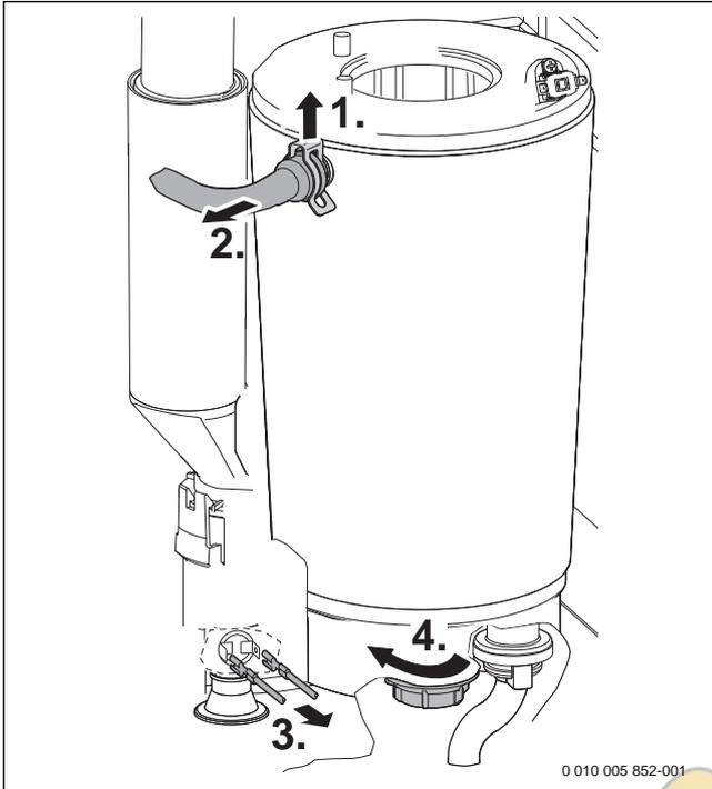
Рис. 65 Отсоедините трубу подающей линии и провода
