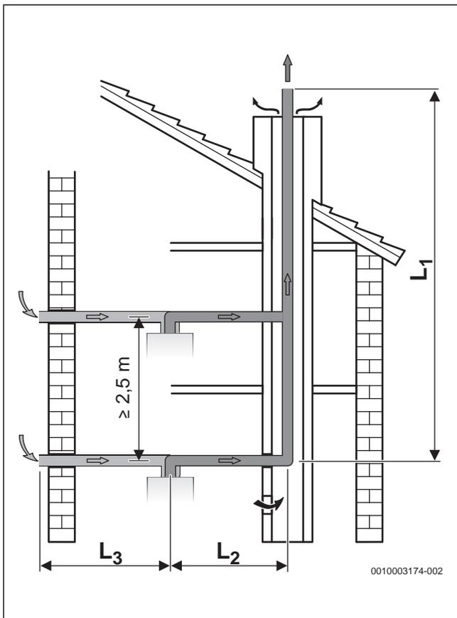
Рис. 19 Подключение нескольких котлов с отдельными трубами по С<sub>83(х)</sub>
