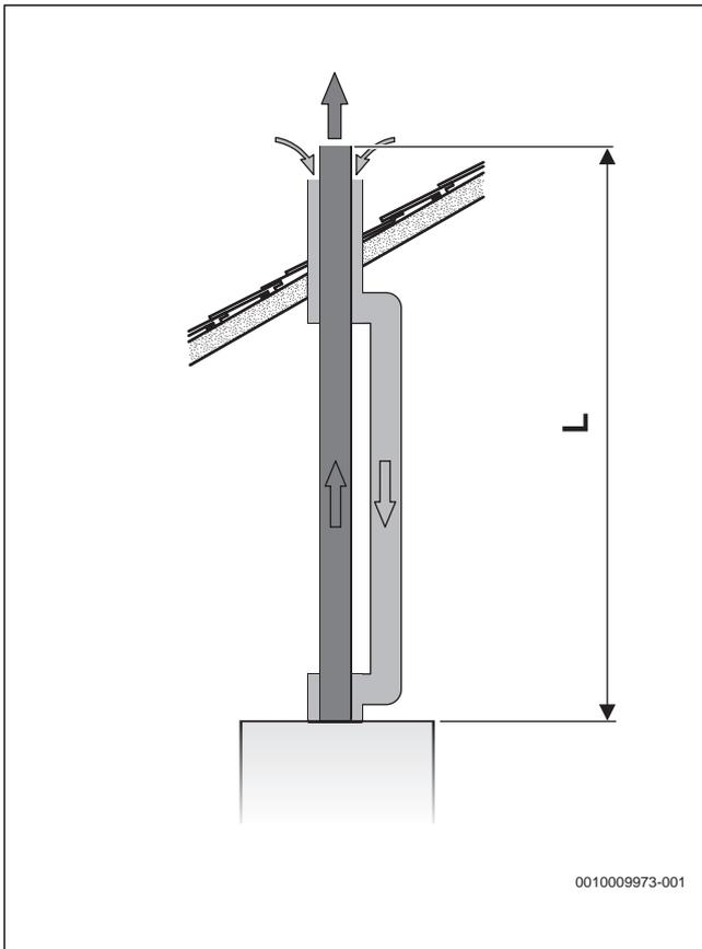
Рис. 15 Вертикальный отвод дымовых газов по  $C_{33(x)}$
