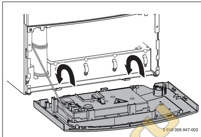
Рис. 24 Установите блок управления в положение для обслуживания
