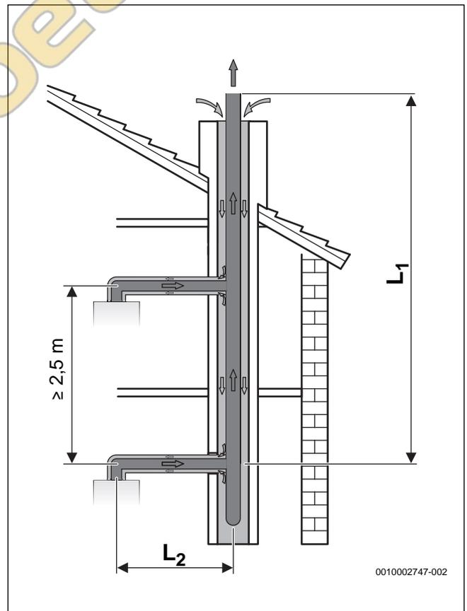
Рис. 18 Подключение нескольких котлов с концентрической трубой по C<sub>43</sub>
