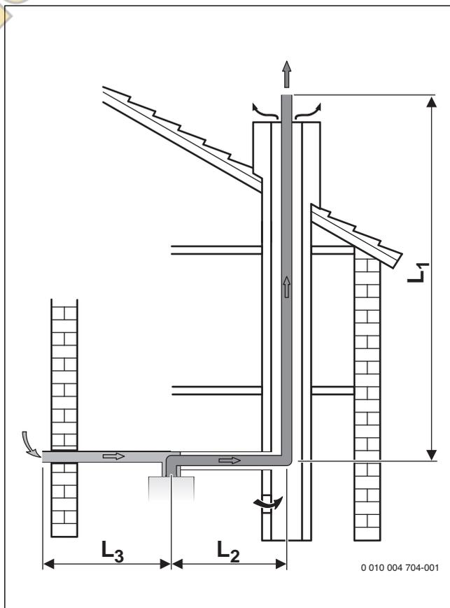
Рис. 10 Труба отвода дымовых газов в шахте по C<sub>53(x)</sub>
