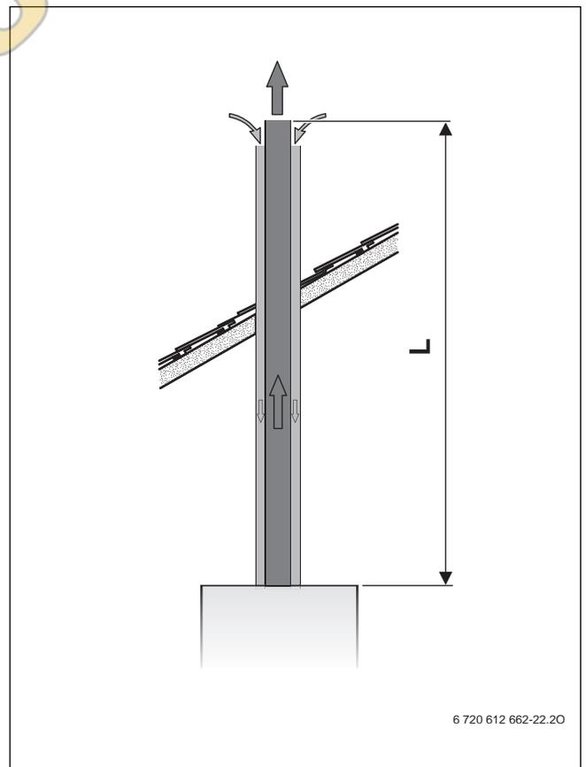
Рис. 14 Вертикальный отвод дымовых газов по C<sub>33(x)</sub>
