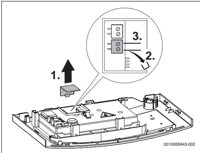
Рис. 28 Подключение регулятора
