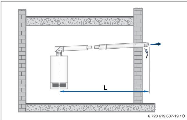
Рис. 16 Варианты монтажа с комплектом WH/WS (C<sub>13</sub>)
