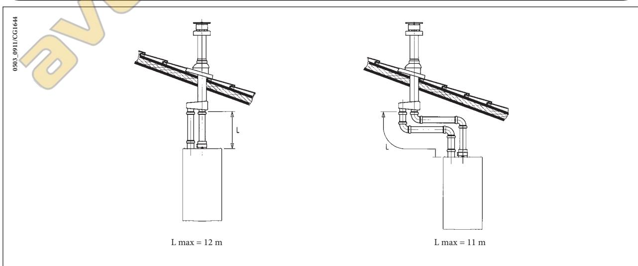
**Обратите внимание!** При установке дымохода убедитесь, что труба хорошо изолирована (напр., стекловолокном) в месте прохода трубы сквозь стену здания.
