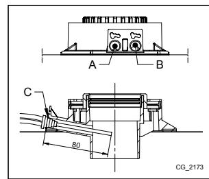
Температуру сгораемого воздуха можно измерить на розетке, имеющейся на контуре воздуховода (**B**), вставив измерительный датчик примерно на 8 см (**C**).
