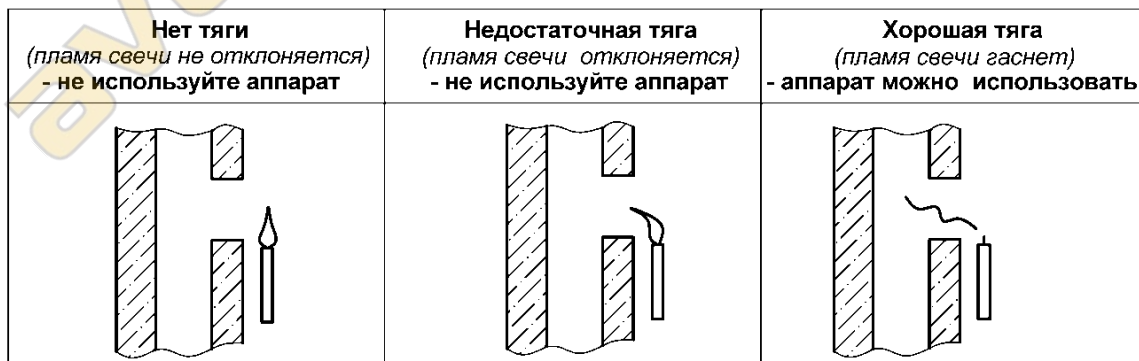
Рисунок 7. Способ проверки тяги в дымоходе
