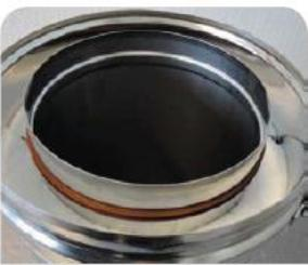
**2.** В системах с избыточным давлением до 200 Па на внутреннюю трубу установить силиконовую (или витоновую) уплотнительную манжету (аналогичное действие выполнить на следующих элементах труб).
