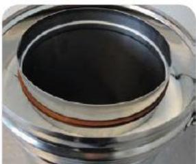
**2.** В дымоходах, работающих под избыточным давлением, во внутреннюю трубу установить уплотнительную манжету (силиконовую или витоновую). То же самое выполнить на последующих элементах труб.
