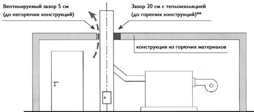
\*\*При температуре дымовых газов выше 450 °C
