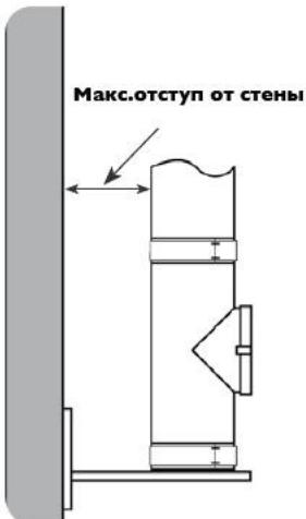
В таблице указан максимальный отступ от стены в зависимости от консоли и диаметра дымохода.
