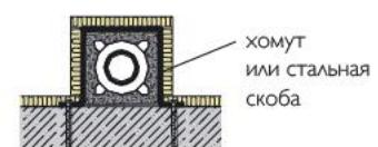
При установке дымовой трубы снаружи здания или в не отапливаемых помещениях необходимо утеплить дымоход панелями из негорючих минеральных волокон, которые точечно крепятся к каменным блокам. Толщина слоя изоляции зависит от конкретных климатических условий и определяется теплотехническим расчётом. Утеплённый дымоход покрывается сеткой с нахлёстом на стену и штукатурится паропропускающей штукатуркой. Утеплённый дымоход можно также облицевать.
