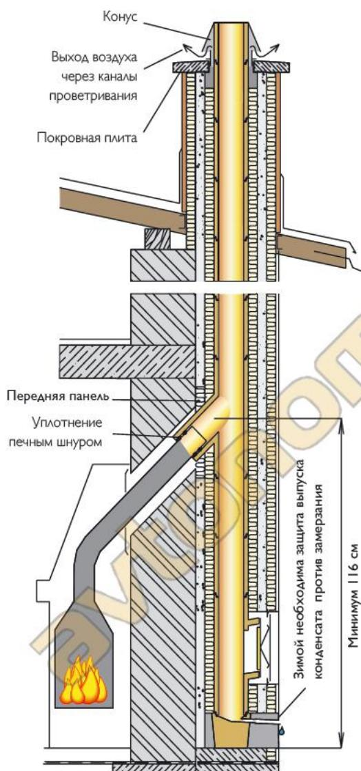
Это решение используется в том случае, если невозможно установить дымовую трубу в помещении, где будут размещены камин или печь. Вентиляционная решетка и дверца для осмотра и очистки оказываются снаружи. При выборе этого решения важно, чтобы в дымоходе не накапливался постоянно конденсат.
