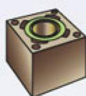
Дымоход без вентиляционного канала
