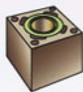
Дымоход без вентиляционного канала
