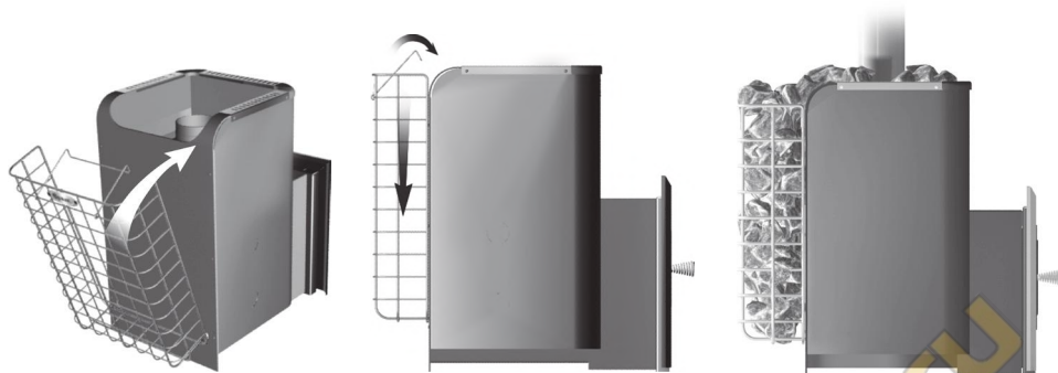
Рисунок- 10. Установка сетки-каменки на печь.
