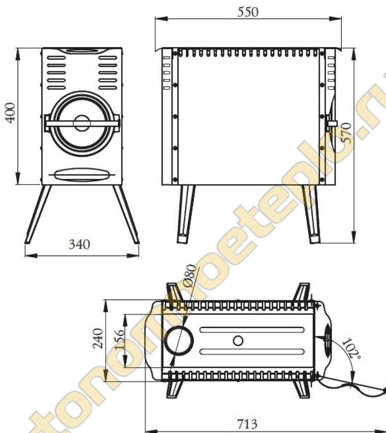
Рисунок 1. Габаритные размеры печи «Пичуга».
