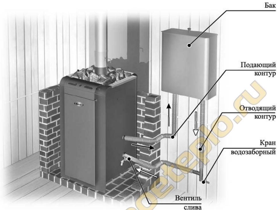
Подъем подающего контура не менее  $20^\circ$ , уклон отводящего контура не менее  $2^\circ$ , в направлении от печи к баку.
