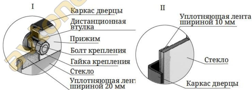
Рисунок 13. Крепление светорозрачного экрана дверцы модели «Витра»
