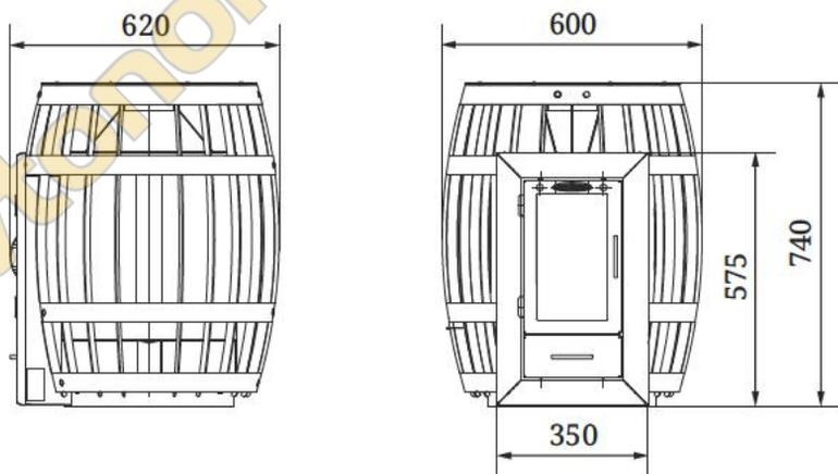
Рисунок 4. Габаритно-монтажные размеры печи «Саяны Inox Люмина КТК»
