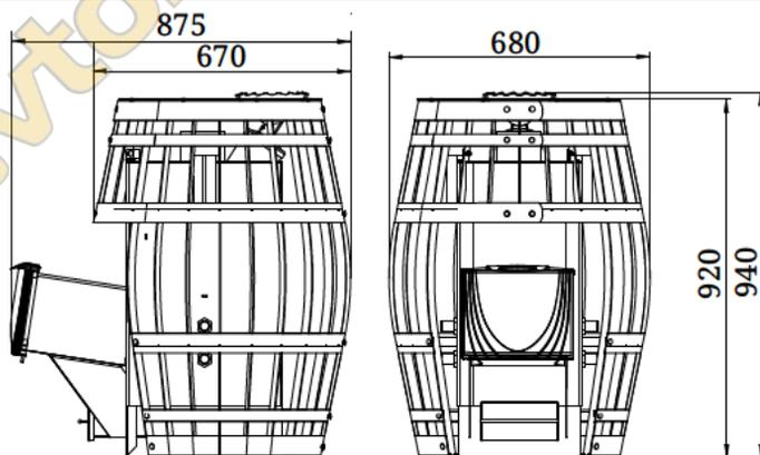
Рисунок 5. Габаритно-монтажные размеры печи «Саяны XXL 2015»
