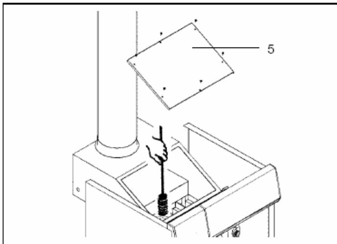
После окончания обслуживания и чистки, провести все выше указанные действия в обратном порядке и проверить герметичность соединений.
