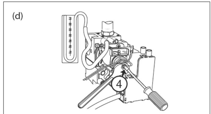
4. По окончании проверки затяните винт «2» и убедитесь, что он затянут плотно.
