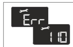
**Защитное отключение из-за низкого давления воды**
