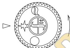
В этом положении кнопка управления держится нажатая до упора(!), одновременно нажимается (несколько раз) пьезозапальник, пока не появится „вечное пламя“. Кнопка держится нажатая (еще 10 сек. после зажигания пламени), пока не сработает термопредохранитель, потом можно пустить ( подача газа к главной горелке остается заблокированной).
