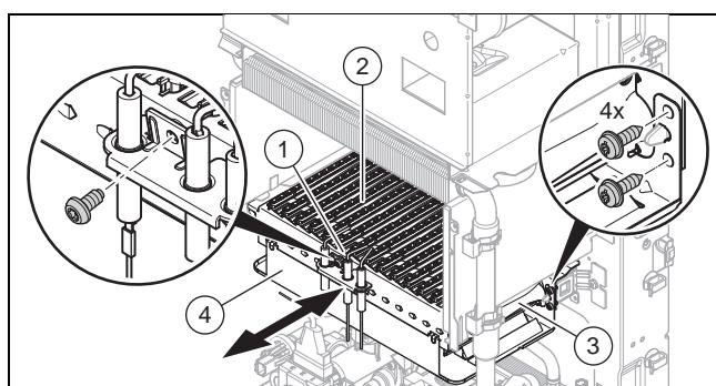
1. Открутите винты на газораспределительной трубе (3).
