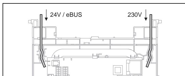
1. Проведите присоединительную проводку подсоединяемых компонентов через кабельный ввод слева и справа на нижней стороне блока электроники.
