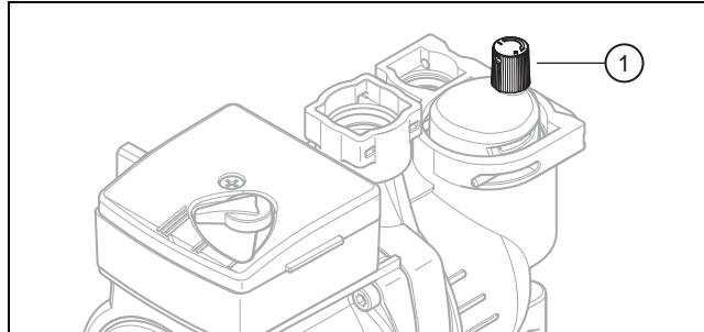
4. Снимите колпачок (1) быстродействующего воздухоотводчика.
