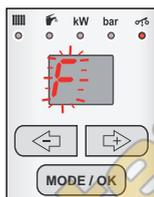
Неисправности котла индицируются посредством появления кода неисправности на дисплее. При этом, начинает мигать буква «F» вместе с соответствующим двузначным числом, обозначающим код неисправности.
