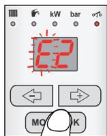
Нажатием кнопки MODE/OK в режиме изображения выбранной эквитермической кривой перейдете в режим настройки эквитермической кривой. Данное состояние индицируется миганием на дисплее котла буквы
