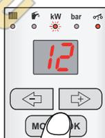
Нажатие кнопки MODE/OK в режиме отображения значения мгновенной мощности котла позволяет перейти в режим настройки мощности котла. Переход в данное состояние сигнализируется
