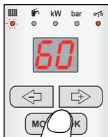
Нажатие кнопки MODE/OK в режиме отображения температуры в системе отопления позволяет перейти в режим регулировки значений параметра температуры отопления. Данное состояние индицируется
