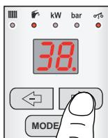
Состояние отображения актуального значения температуры горячей воды индицируется посредством загорания светодиода
