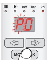
Нажатием кнопки MODE/OK в режиме отображения параметра смещения эквитермической кривой перейдете в режим настройки параметра смещения эквитермической кривой.
