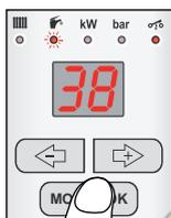
Нажатие кнопки MODE/OK в режиме отображения температуры горячей воды позволяет перейти в режим установки температуры горячей воды в бойлере косвенного нагрева.
