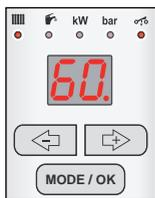
Состояние отображения актуального значения температуры воды в системе индицируется посредством загорания светодиода
