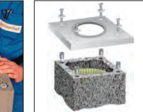
37. «Комплект для монтажа верхней части дымовой трубы» с готовой покровной плитой включает: керамическую трубу, распорное кольцо, конус, герметик, уплотнительную массу и наглядную инструкцию по монтажу. При использовании готовых элементов для монтажа верхней части дымовой трубы консольная и покровная плиты не устанавливаются.
